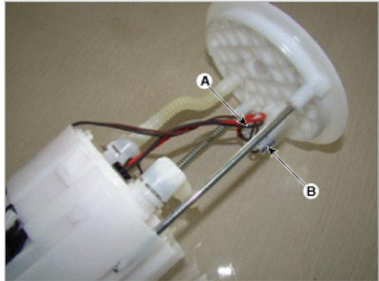
3. 释放固定挂钩后，拆卸燃油量传感部(A)。
