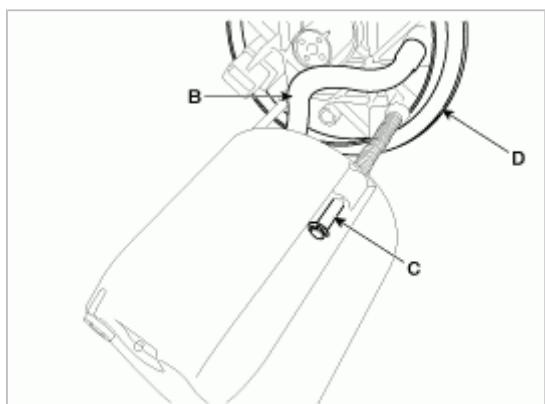
6. 释放固定挂钩后，拆卸储油杯(A)。
